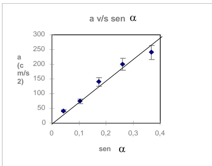
En el gráfico, al determinar la pendiente, ésta arroja un valor aproximado de 733 cm/seg<sup>2</sup>, el cual al ser comparado con el valor esperado ( $g = 980 \text{ cm/seg}^2$ ), se obtiene un 25% de diferencia entre el valor teórico y el experimental.
